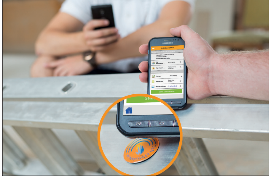
Vom Bautrockner bis zur Leiter werden alle Werkzeuge und Geräte mit der mobilen Geräteverwaltung via NFC organisiert. (Foto: WinWorker)
